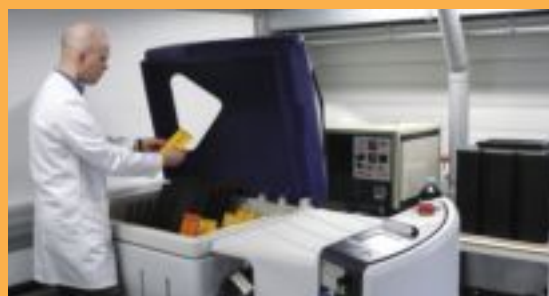
Test w mgłę solnej wg DIN EN ISO 9227
